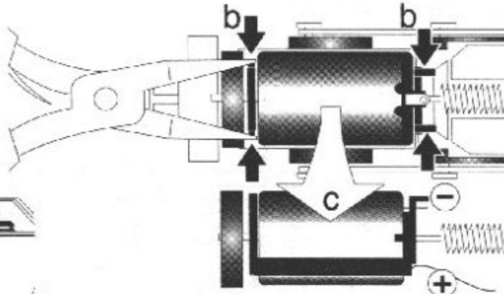
Einbau Selectrix Lokdecoder
